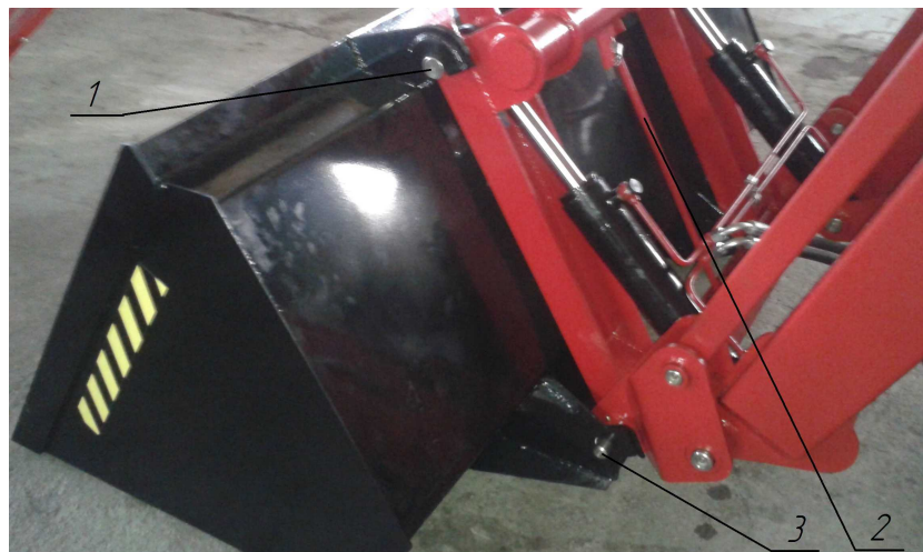
Рис. 2 Монтаж рабочего органа
